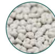
Foto 6: Regranulados de PE
