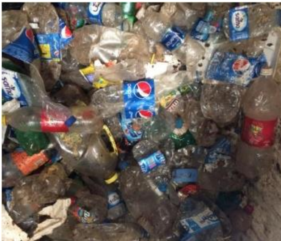
图片 8：从残余废弃物中分拣出的受污染 PET 瓶（© cyclos 2019）
