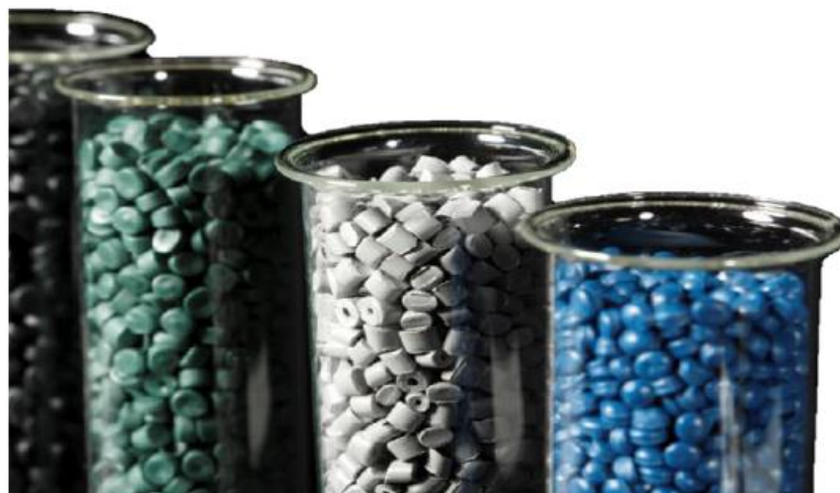
图片 2：PE 再生料 (©Vogt-Plastic GmbH 2020)
